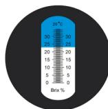
3. После проведения измерений протрите влажной марлей поверхность призмы и внутреннюю поверхность защитной крышки.
